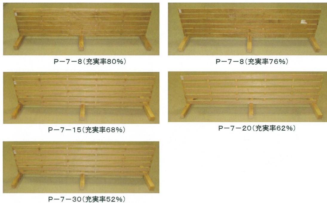
写真1 実験模型（全体）
