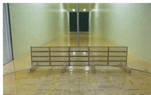
写真2 風洞内への模型の設置状況
