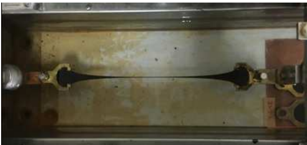
図-11 荷重測定型伸度試験の実施状況
