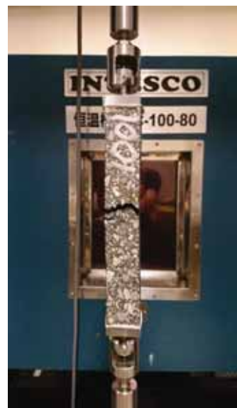
写真 4.2 直接引張試験の実施状況
