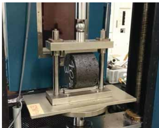
写真 3.2 間接引張試験の実施状況
