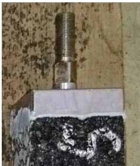
写真 4.1 直接引張試験用治具の接着状況
