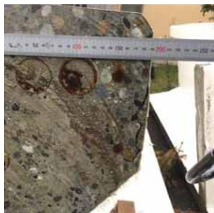
写真 3-7 ブロック 3 山側下フランジ側面のかぶり深さ
