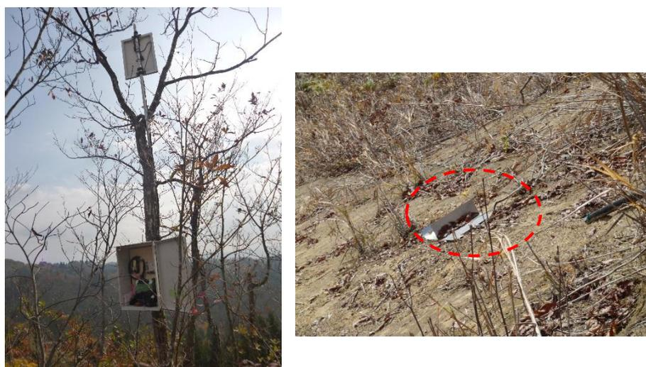
図3 測線L1のグライド計用ソーラーパネル・ロガー(左)とソリ本体(右)
