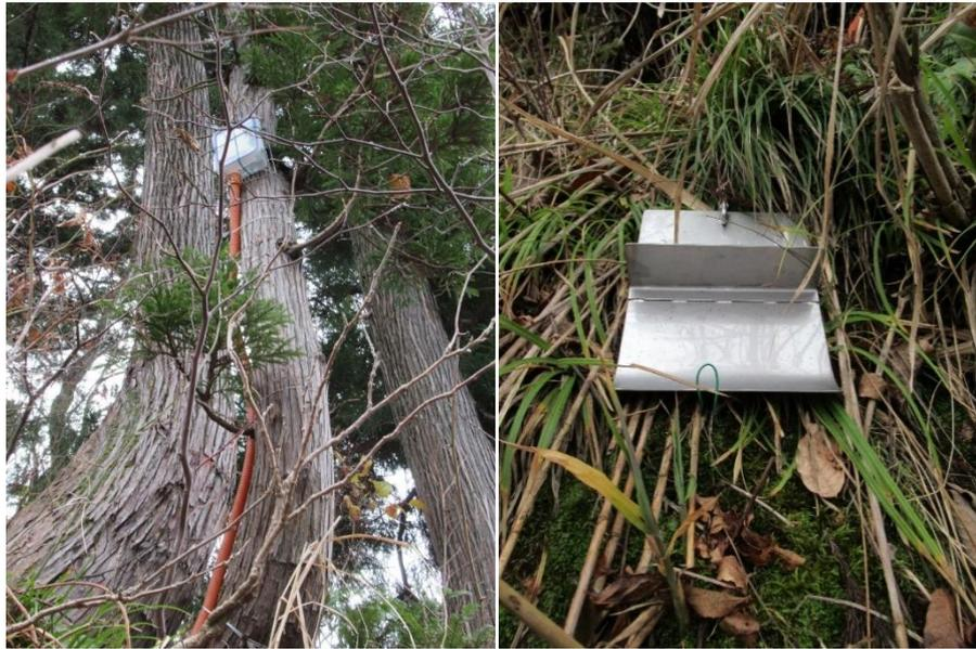
図5 測線L3 頭部の木※に設置したグライド計ロガー（左）とソリ本体（右）
