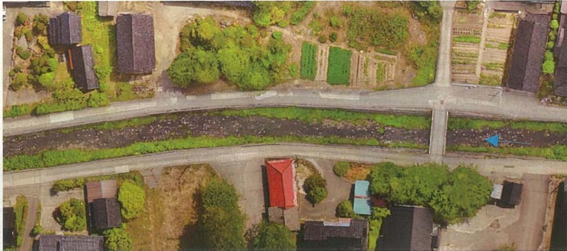
写真－5 集落内での単調な流れ（ダムの影響により粗粒化が進行している）
