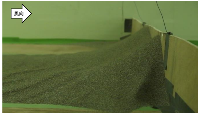
図5 実験後の堆積状況 (30分後)
