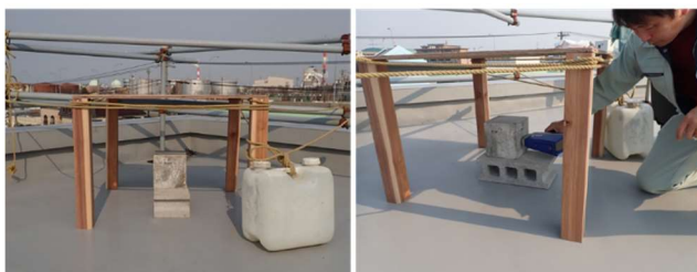
コンクリート供試体 測定状況写真（東西南北上の5面を、月に数回頻度で測定）
