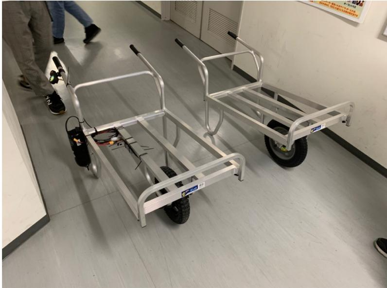
図1 e-cat kit を装着した電動アシスト台車（左）の外観
