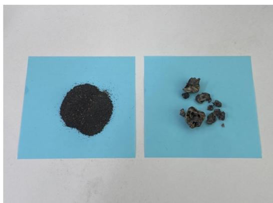
図5 採取した砂鉄（左）とできた鉄（右）
