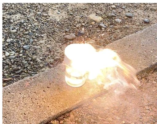
図6 テルミット反応の様子
