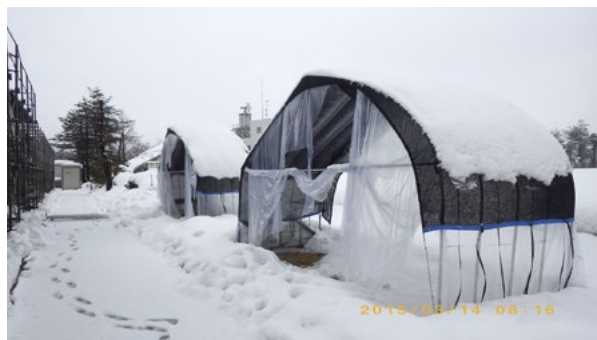
図4 ビニールハウスへの冠雪実験(雪氷防災研究センター構内 H.27.3.14)
