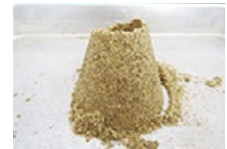
＜湿潤状態＞ スランプせずコーンの形を保つ 再度、乾燥調整する
