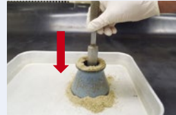
③ 試料をフローコーンに詰め 25回突く
