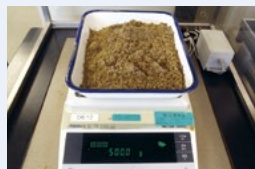
② 表乾状態質量試料測定
