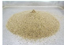
＜気乾状態＞ 表乾状態より乾燥側 再度、加水調整する
