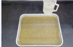
① 試料を吸水させる (24h)
