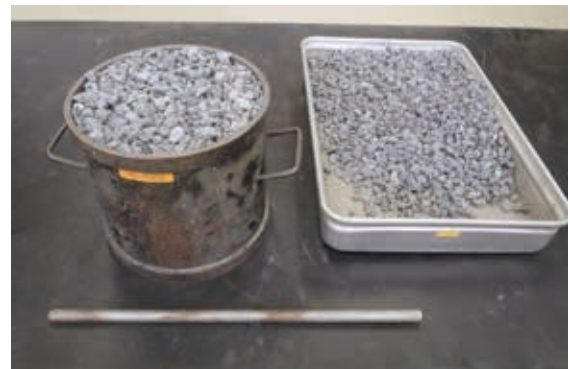
写真2.10リットル容器を使用した棒突き方(ならし後)
