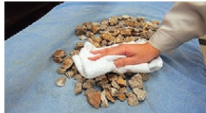
② 吸水性の布で目に見える水膜をふき取り、表乾状態とする。
