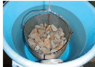
④ 水中質量を計量する。
