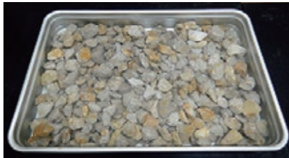
① 4.75mmふるいにとどまる試料を採取し、水洗い後に吸水させる。
