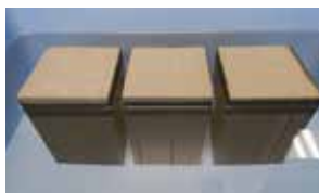
水面と平行にし、かつ上部1cmを常に水面上になるように48時間水浸。
