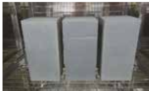
試験体を乾燥機で恒温になるまで乾燥。
