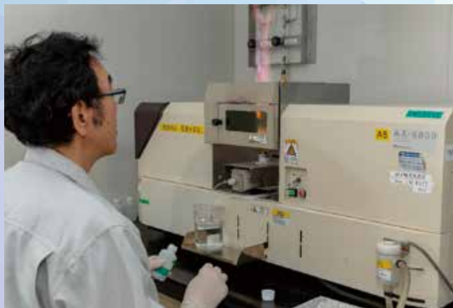
骨材のアルカリシリカ反応性試験（新潟本所）
