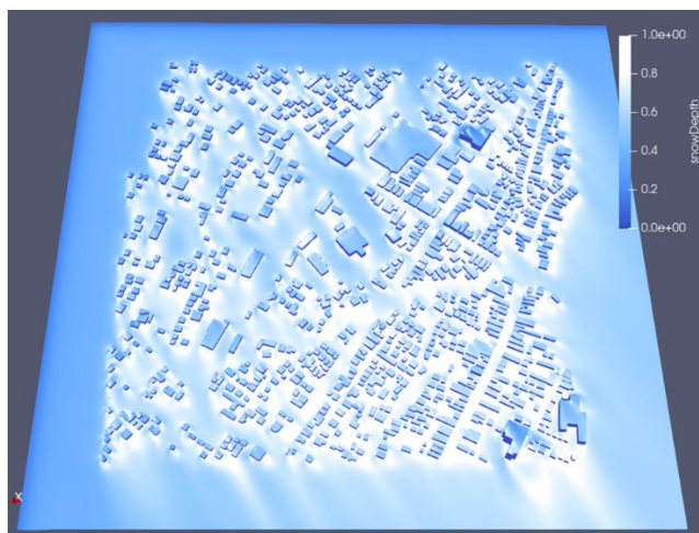
図 4-8 飛雪解析が風速 5m/s の融雪解析
