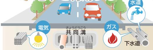
道路の下には生活に必要な水道管、下水道管、ガス管、電線などが埋められています。
