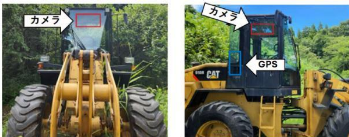
図3 除雪車へのカメラとGNSSの設置状況
