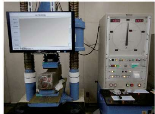
\square 150\text{mm} 供試体による曲げ強度試験風景
